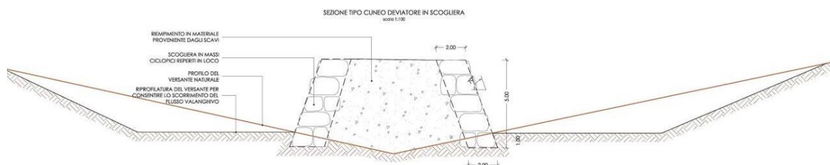
Fig.47. Schema di vallo deviatore di flusso valanghivo
